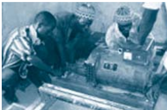
Des artisans locaux montent un groupe électrogène sur une plate-forme multifonctionnelle
