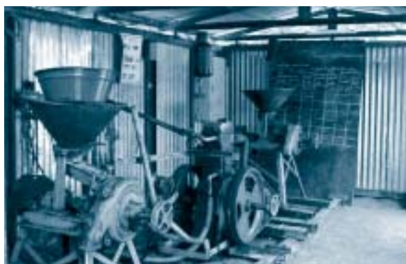
Une plate-forme multifonctionnelle équipée d'outils de transformation des aliments.
